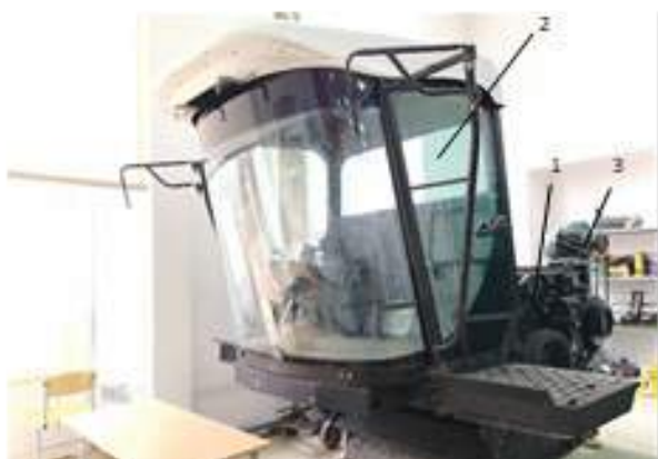
Экспериментальный стенд для исследования виброакустических параметров на основе зерноуборочного комбайна
